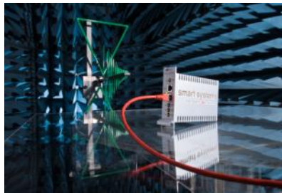
EMV-Prüfung eines Produkts in der Absorberhalle des EMV-Prüfzentrums Seibersdorf
